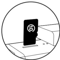
将存储卡插入记录仪机身侧面卡槽，注意内存卡插入方向的正反面。请使用正规厂商生产的 TF 存储卡，可选择容量8GB-128GB、读写速度不低于 U1/Class10 级的存储卡。
